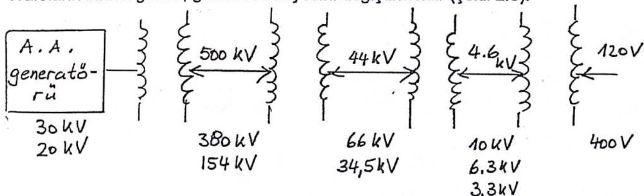
Şekil 2.3 Trafo kullanılarak enerjinin taşınması
