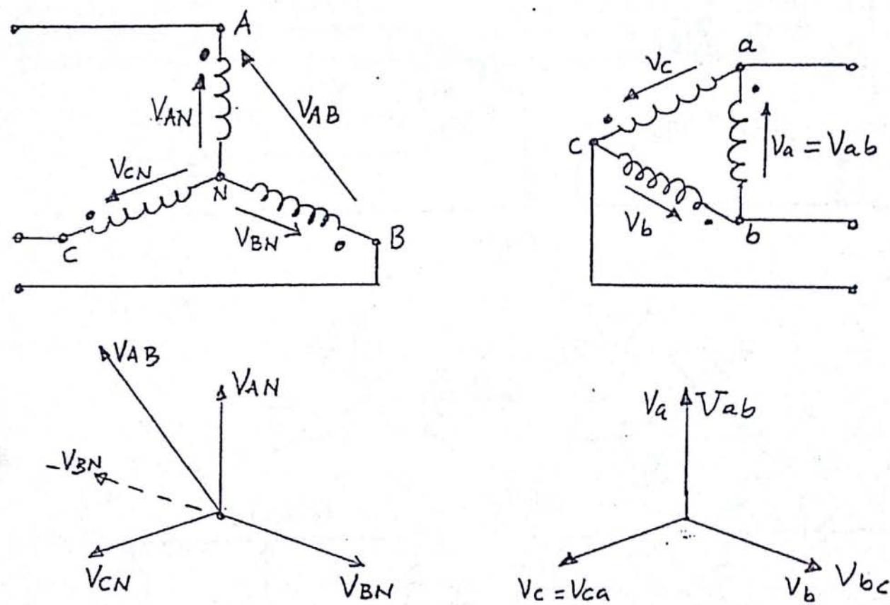
Şekil 2.16. Üç fazlı transformatörlerde faz kaydırma
