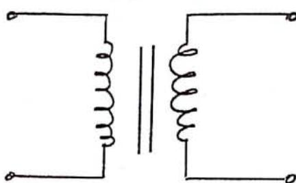
Şekil 2.2 İki sargılı transformatörün şematik gösterilişi
