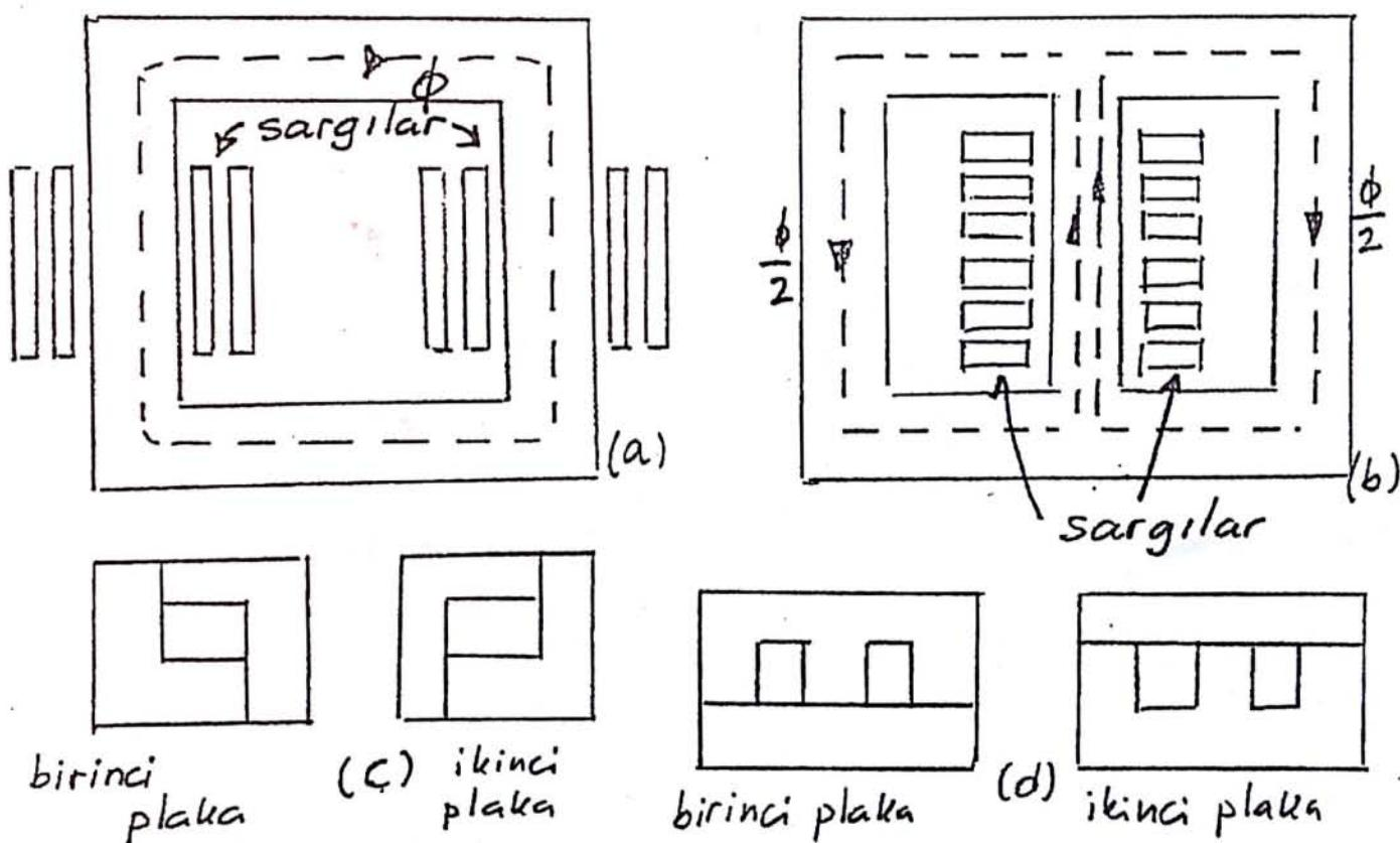
Şekil 2.1 Çekirdek konstrüksiyonu
