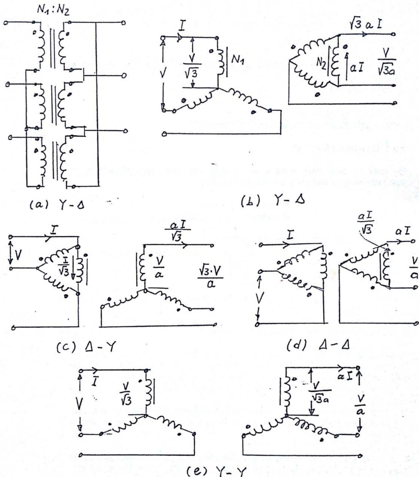
Şekil 2.15 Üç fazlı trafo bağlantıları
