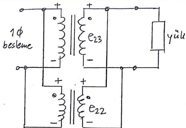
Şekil 2.7 Bir fazlı transformatörün paralel bağlantısı
