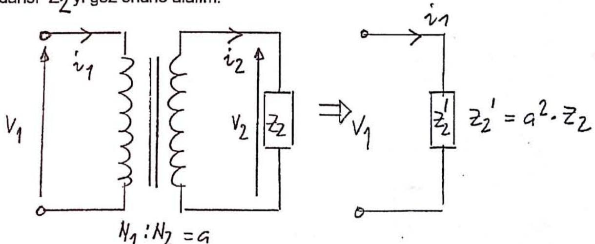
Şekil 2.5. İdeal transformatörde empedans transferi
