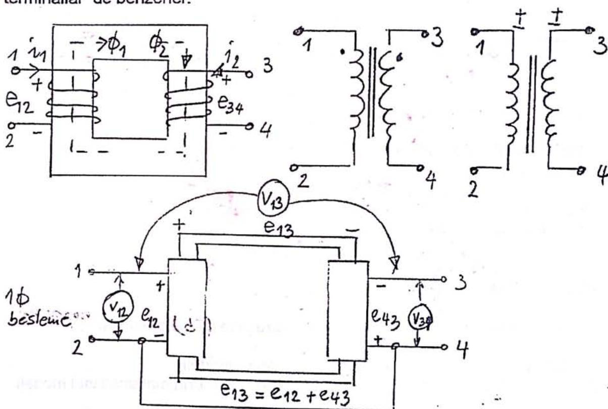
Şekil 2.6 Polarite belirlemesi
